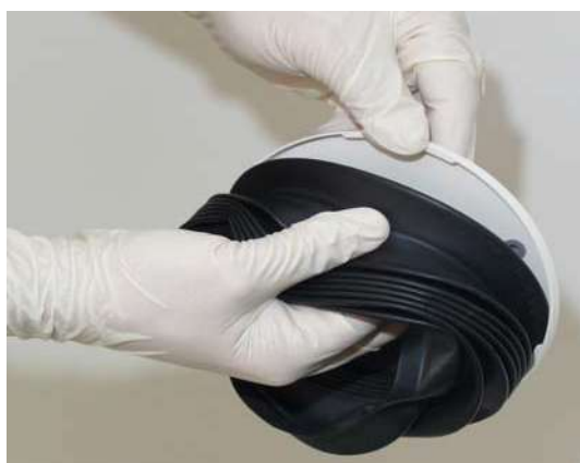
РИСУНОК 7-7 Отсоединение верхней панели от сифона
