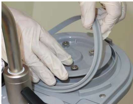
РИСУНОК 7-9 Удаление О-кольца купола сильфона
