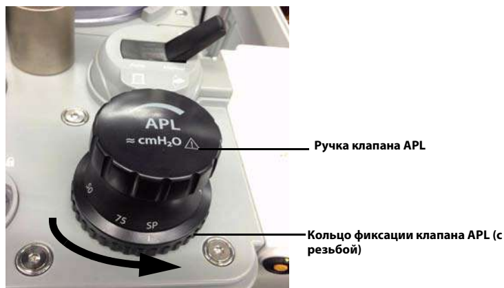
РИСУНОК 7-14 Извлечение клапана APL
