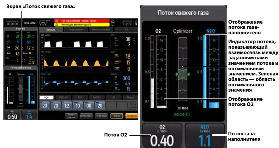
РИСУНОК 3-12 Электронная система управления потоком в режиме управления прямым потоком
