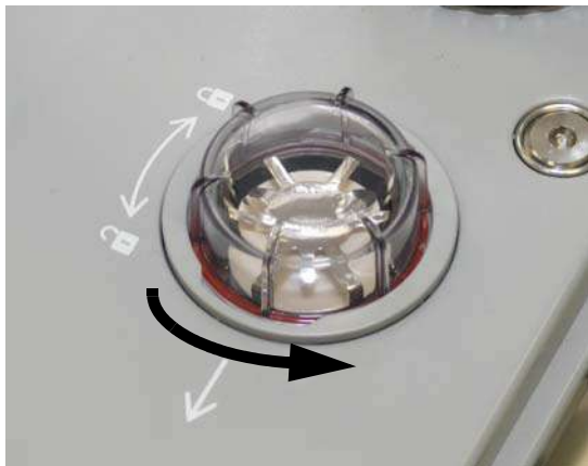
РИСУНОК 7-11 Снятие крышки клапана
