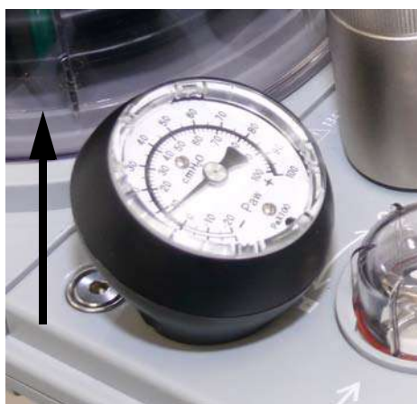
РИСУНОК 7-15 Извлечение манометра PAW
