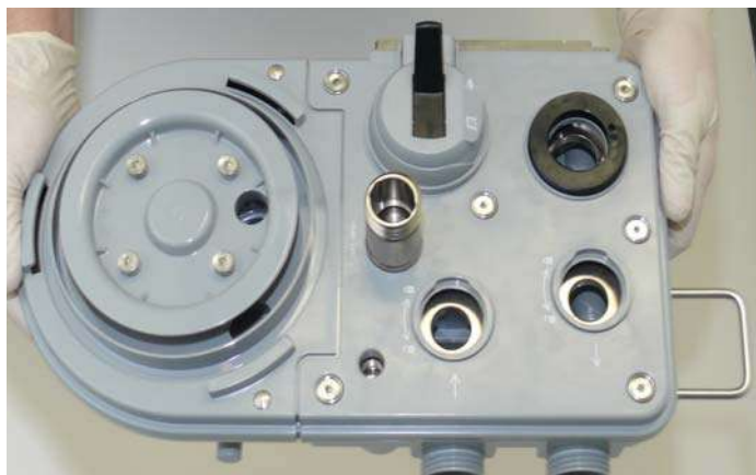
РИСУНОК 7-21 Снятие блока дыхательного контура, вид сверху
